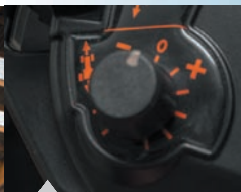
Ручка системи регулювання плавності ходу Важіль Power Control (на замовлення): інтенсивність човникового режиму руху можна відрегулювати залежно від виконуваної роботи.
