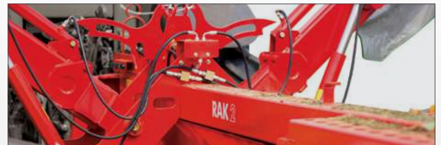
Блокування роторів в транспортному положенні
