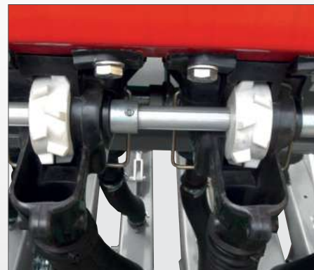
Висіваючий апарат для мінеральних добрив
