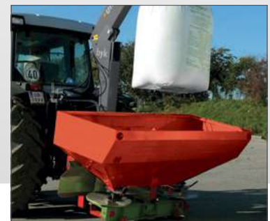
Навантажувач біг-бегів ВУК - дозволяє швидко завантаження добрив у бегах до 1000 кг
