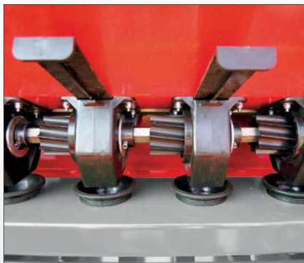
Висіваючий апарат для насіння
