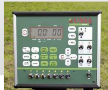
Стандартний комп'ютер Spray фірми Muller Elektronik призначений для автоматичного утримання заданої норми виливу незалежно від швидкості руху
