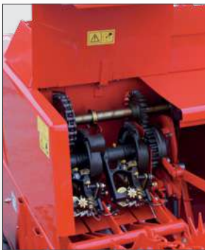
Безвідмовні оригінальні в'язучі апарати Raspre
