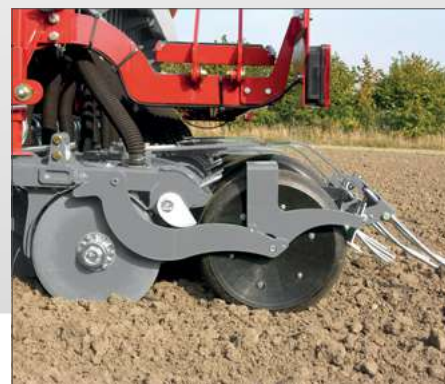
Важкий сошник з прикочуючим колесом дотиск 65 кг
