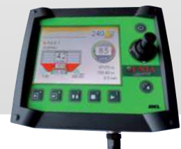
Комп'ютер SUPERIOR - утримує задану норму внесення незалежно від швидкості руху
