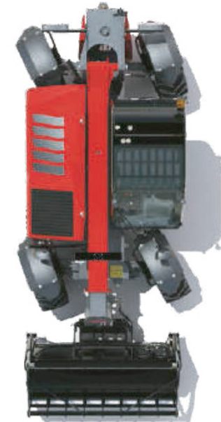
Крабовий хід – для більш ефективної роботи в обмеженому просторі
