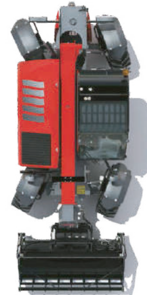
Управління усіма колесами – для мінімального радіусу повороту
