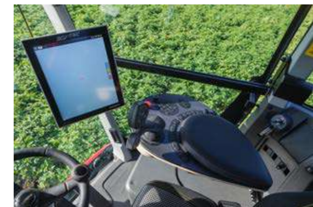
EcoTronicPlus в обприскувачах Conдор Endurance: Ця система оснащена абсолютно новим, повністю інтегрованим підлокітником та джойстиком для простоти використання та підвищення продуктивності.
